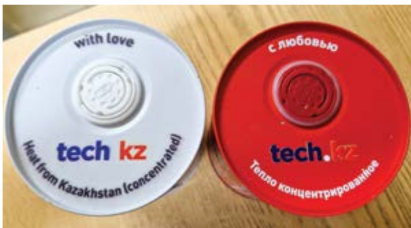
Изменяя в профиле печати размер капли и напряжение, можно регулировать «глубину резкости». На фото – крышка банки, напечатанная на стандартном профиле и профиле, подобранном для печати на объектах, удаленных от головки.
